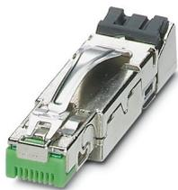
Conector RJ45, formato: RJ45, grau de proteção: IP20, número de polos: 8, 1 GBit/s, CAT5, material: Metal, tipo de conexão: Conexão IDC, bitola de conexão: AWG 23- 22, saída de cabo: reto, cor: verde, Ethernet/PROFINET
