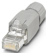
Conector RJ45, formato: RJ45, grau de proteção: IP20, número de polos: 4, 100 MBit/s, CAT5, material: Plástico, tipo de conexão: Conexão IDC, saída de cabo: reto, cor: cinza A RAL 7042, PROFINET
