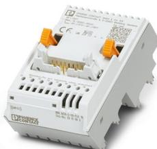
Oito amplificadores condicionadores de sinal e transdutores MINI Analog Pro podem ser conectados a um controlador através de adaptadores e cabos de sistema, com esforço de cabeamento reduzido ao mínimo e totalmente sem erros.
