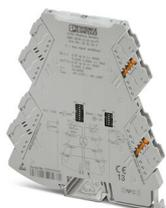
Amplificador condicionador de sinal de 3 vias com sistema de conexão plugável e comutação de gama de medição para o isolamento galvânico de sinais analógicos unipolares e bipolares. Entrada/saída configurável através de chave DIP. Sistema de conexão push-in, configuração padrão.
