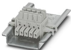
Conector para trilho de fixação (TBUS), 5 pólos, para jumpeamento da tensão de alimentação, encaixável sobre trilhos de fixação de NS 35/... conforme EN 60715
