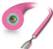
Cabo universal GOF, 12 fios, cabo de fibras soltas para instalação fixa, proteção não metálica contra roedores, decapagem fácil, resistente a UV, alta resistência mecânica e térmica, produz pouca fumaça, sem halogênio e autoextinguível, resistência ao esmagamento melhorada, à prova de água longitudinal e transversalmente
