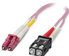
Cabo de fibra óptica montado, cabo Zipcord, fibra de vidro multimodo 50/125 µm, OM4, conector: LC / SC-RJ, grau de proteção: IP20, para a instalação em canaletas para cabos ou quadros de comando
