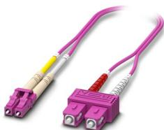
Cabo de fibra óptica montado, cabo Zipcord, fibra de vidro multimodo 50/125 µm, OM4, conector: SC / LC, grau de proteção: IP20, para a instalação em canaletas para cabos ou quadros de comando
