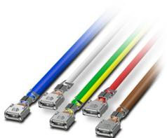
CHARX connect modular, Conjunto de cabos para a tomada de carga da infraestrutura, Acessórios, com luva de encaixe em um lado, Exclusivamente para a conexão em tomadas de carga de infraestrutura da geração 2 da Phoenix Contact, Tipo 2, IEC 62196-2, 32 A / 250 V (AC), Condutores individuais, comprimento: 0,7 m, Montagem de encaixe
