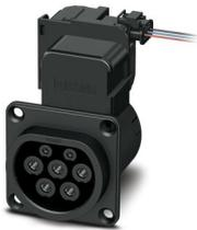
CHARX connect modular, Tomada de carga da infraestrutura, Angular, Premium, com sensores de temperatura, Com LED (conexão catódica comum), para o carregamento com corrente alternada (AC) de veículos elétricos (EV), compatível, Tipo 2, IEC 62196-2, 32 A / 480 V (AC), sem condutores individuais, atuador de travamento: 12 V, 3 pólos, Montagem na parede traseira, Rosca M5, caixa: preto, Logotipo PHOENIX CONTACT
