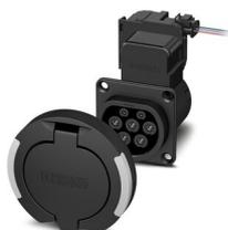
CHARX connect modular, Tomada de carga da infraestrutura, Angular, Premium, Conjunto, Com tampa de proteção redonda, com sensores de temperatura, Com LED (conexão catódica comum), para o carregamento com corrente alternada (AC) de veículos elétricos (EV), compatível, Tipo 2, IEC 62196-2, 32 A / 480 V (AC), sem condutores individuais, atuador de travamento: 12 V, 3 pólos, Montagem na parede traseira, Rosca M5, caixa: preto, Logotipo PHOENIX CONTACT
