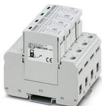
CHARX protect advanced, dispositivo de proteção contra raios / surtos plugável, conforme tipo 1/2 / classe I/II, para redes de fornecimento de energia trifásicas com N e PE separados (sistema de 5 condutores: L1, L2, L3, N, PE). Especialmente adequado para a utilização na eletromobilidade.
