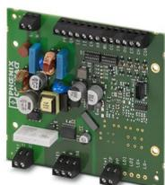
O controlador de carregamento EV-CC-AC1-M3-CC-SER-PCB como placa de circuito impresso para carregar veículos elétricos em uma rede de corrente alternada trifásica conforme IEC 61851-1, modo 3. Otimizado para dispositivos de carga com conector de carga para veículos montado de forma fixa. Todas as funções de carga e ajustes de configuração abrangentes já estão integrados.
