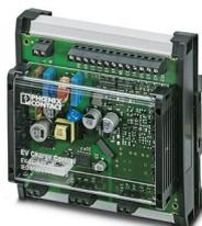
O controlador de carregamento EV-CC-AC1-M3-CBC-SER-HS com caixa para a montagem em trilho de fixação serve para carregar veículos elétricos na rede de corrente alternada trifásica conforme IEC 61851-1, modo 3. Otimizado para dispositivos de carga com conector de carga de veículos montado de forma fixa. Todas as funções de carga e ajustes de configuração abrangentes já estão integrados.
