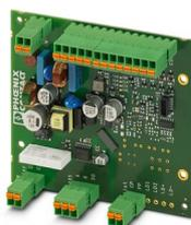
O controlador de carregamento EV-CC-AC1-M3-CC-SER-PCB-MSTB como placa de circuito impresso para carregar veículos elétricos conforme IEC 61851-1, modo 3, otimizado para dispositivos de carga com conector de carga para veículos montado de forma fixa. Conexão através de conector para placa de circuito impresso na régua básica.
