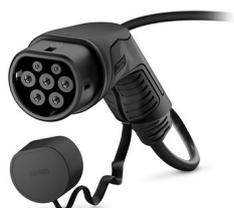
CHARX connect comfort, Condutor de carga AC, com conector de carga para veículos e extremidade livre do condutor, para o carregamento com corrente alternada (AC) de veículos elétricos (EV), com tomadas de carga do veículo tipo 2, com tampa de proteção, Tipo 2, IEC 62196-2, Logotipo PHOENIX CONTACT, cabo: 5 m, preto, reto
