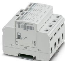
CHARX protect basic, dispositivo de proteção contra surtos plugável, conforme tipo 2 / classe II, para redes de fornecimento de energia trifásicas com N e PE separados (sistema de 5 condutores: L1, L2, L3, N, PE). Especialmente adequado para a utilização na eletromobilidade.
