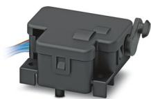
CHARX connect modular, Travamento, Acessórios, Com condutores individuais, Sem suporte, Para travar tomadas de carga de infraestrutura em estado conectado, Tipo 2, GB/T, IEC 61851-1, Condutores individuais, comprimento: 0,5 m, atuador de travamento: 24 V, 4 polos
