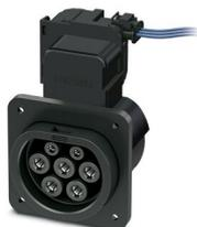
CHARX connect basic, Tomada de carga da infraestrutura, Angular, com sensores de temperatura, para o carregamento com corrente alternada (AC) de veículos elétricos, GB/T, GB/T 20234.2-2015, 32 A / 250 V (AC), Condutores individuais, comprimento: 0,5 m, Montagem na parede traseira, caixa: preto, Logotipo PHOENIX CONTACT
