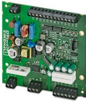
O controlador de carregamento EV-CC-AC1-M3-CBC-SER-PCB como placa de circuito impresso serve para carregar veículos elétricos na rede de corrente alternada trifásica conforme IEC 61851-1, modo 3. Todas as funções de carga, ajustes de configuração abrangentes e uma ativação de travamento já estão integrados.
