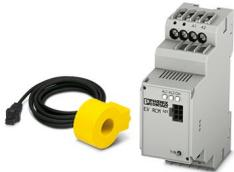
O módulo de corrente de fuga diferencial destina-se ao registro da corrente de fuga AC e DC em pontos de carregamento de corrente alternada. O dispositivo de proteção hierarquicamente superior (por ex. disjuntor de corrente de fuga) é protegido contra possíveis correntes de fuga DC. Está disponível uma variante do produto com 1 ou 2 canais.
