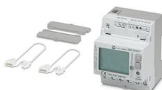
Contador de energia trifásico para a medição de potência ativa com medição direta em redes de até 500 V / 80 A, com saída S0, com entrada digital e interface RS-485, certificado conforme a diretiva MID
