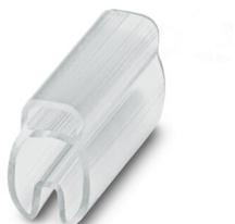
Porta-identificação de condutor, transparente, não impresso, tipo de montagem: de enfiar, faixa de diâmetro de cabo: 4 ... 7 mm, tamanho para gravação: 15 x 4 mm
