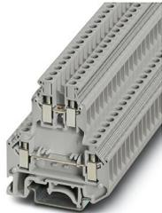
Bornes de dois níveis, tensão nominal: 500 V, corrente nominal: 32 A, tipo de conexão: Conexão a parafuso, 1. e 2o. nível, Bitola: 4 mm<sup>2</sup>, perfil de conexão: 0,2 mm<sup>2</sup> - 4 mm<sup>2</sup>, tipo de montagem: NS 35/7,5, NS 35/15, NS 32, cor: cinza
