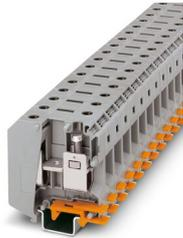
Terminal de alta corrente, tensão nominal: 1000 V, corrente nominal: 150 A, quantidade de conexões: 2, número de polos: 1, tipo de conexão: Conexão a parafuso, Bitola: 50 mm<sup>2</sup>, perfil de conexão: 16 mm<sup>2</sup> - 70 mm<sup>2</sup>, tipo de montagem: NS 35/7,5, NS 35/15, NS 32, NS 35/15-2,3, cor: cinza
