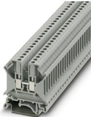
Borne de passagem, tensão nominal: 800 V, corrente nominal: 32 A, quantidade de conexões: 2, tipo de conexão: Conexão a parafuso, Bitola: 4 mm<sup>2</sup>, perfil de conexão: 0,2 mm<sup>2</sup> - 6 mm<sup>2</sup>, tipo de montagem: NS 35/7,5, NS 35/15, NS 32, cor: cinza
