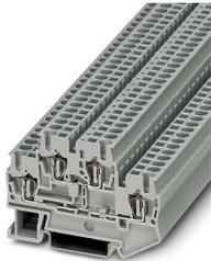
Borne à mola de dois níveis, tensão nominal: 500 V, corrente nominal: 22 A, tipo de conexão: conexão à mola, Bitola: 2,5 mm<sup>2</sup>, perfil de conexão: 0,08 mm<sup>2</sup> - 4 mm<sup>2</sup>, tipo de montagem: NS 35/7,5, NS 35/15, cor: cinza
