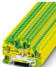
Borne terra duplo, quantidade de conexões: 4, tipo de conexão: conexão à mola, perfil de conexão: 0,08 mm<sup>2</sup> - 4 mm<sup>2</sup>, tipo de montagem: NS 35/7,5, NS 35/15, cor: verde-amarelo
