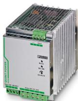
Fonte de alimentação com ciclo primário QUINT POWER, Conexão a parafuso, Montagem do trilho de fixação, SFB Technology (Selective Fuse Breaking), entrada: 3 fásico, saída: 24 V DC / 40 A
