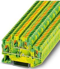
Borne terra duplo, quantidade de conexões: 4, tipo de conexão: Conexão Push-in, 1. e 2o. nível, Bitola: 2,5 mm<sup>2</sup>, perfil de conexão: 0,14 mm<sup>2</sup> - 4 mm<sup>2</sup>, tipo de montagem: NS 35/7,5, NS 35/15, cor: verde-amarelo
