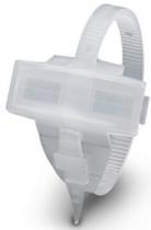
Identificador de cabos de plástico, transparente, não impresso, tipo de montagem: Montagem de agrupadores de cabos, faixa de diâmetro de cabo: 10 ... 25 mm, tamanho para gravação: 29 x 8 mm
