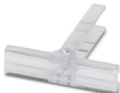
Marcador de réguas de bornes, para identificação de réguas, altura regulável, para utilização em bases E/UK, E/NS 35 N ou CLIPFIX 35, tamanho do campo para inscrição: 44 x 7 mm
